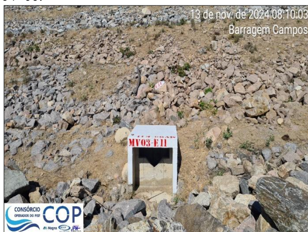
Foto 6.27: Medidor de vazão MV-03 na estaca 11+00.
