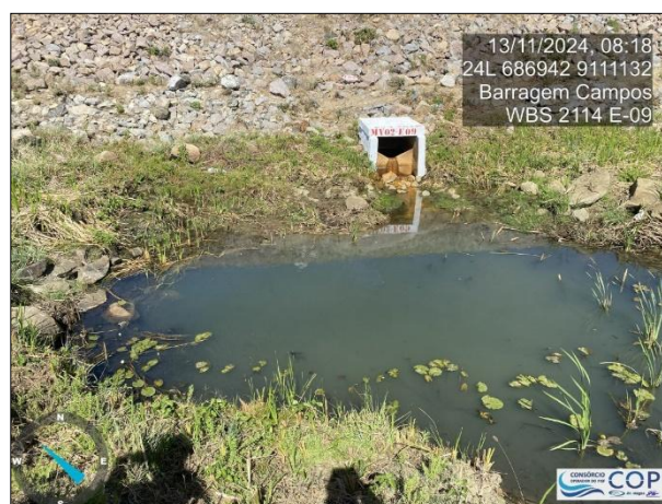
Foto 6.26: Medidor de vazão MV-02 na estaca 09+00.
